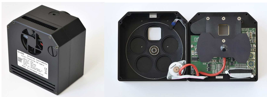
• Obrázek 4. Umístění ventilátoru pro chlazení Peltierových článků a vnitřek CCD kamery s filtrovým kolem pro 5 různých filtrů
