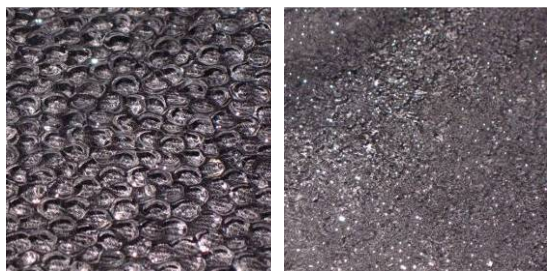
Obr.4. Vzorka A - difúzor s hrubšou štruktúrou (vľavo), Vzorka B - difúzor s jemnejšou štruktúrou povrchu (vpravo)
