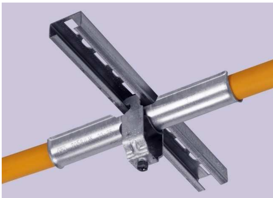
• Obrázek 6: Třmenová příchytka OBO typ 2056M s podélnou opěrkou 2058LW délky 200 mm k montáži po 600 mm
