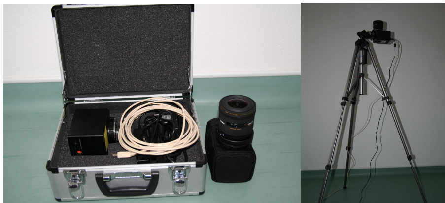
• Obrázek 1. CCD kamera vybavená objektivem Fish Eye a umístěná na stativu pro snímání jasů celého horního poloprostoru.
